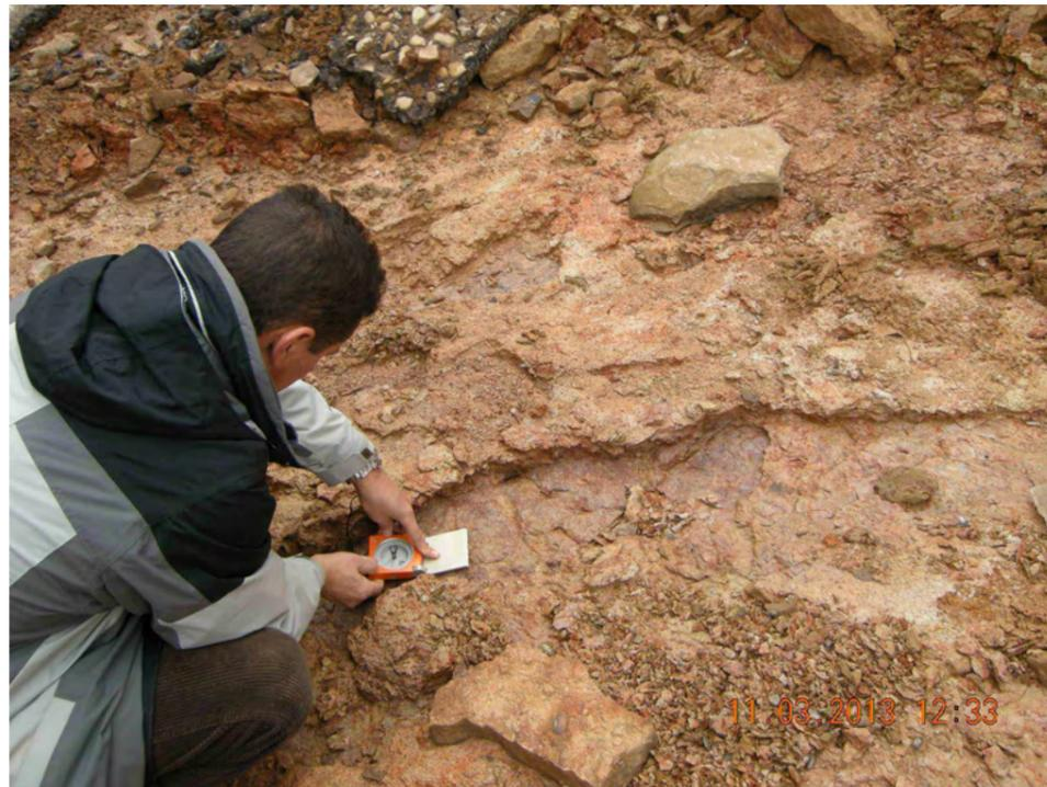
**Fotografía 30:** Espesor y orientación de la capa de arcillas que constituye el nivel o plano de despegue del deslizamiento.
