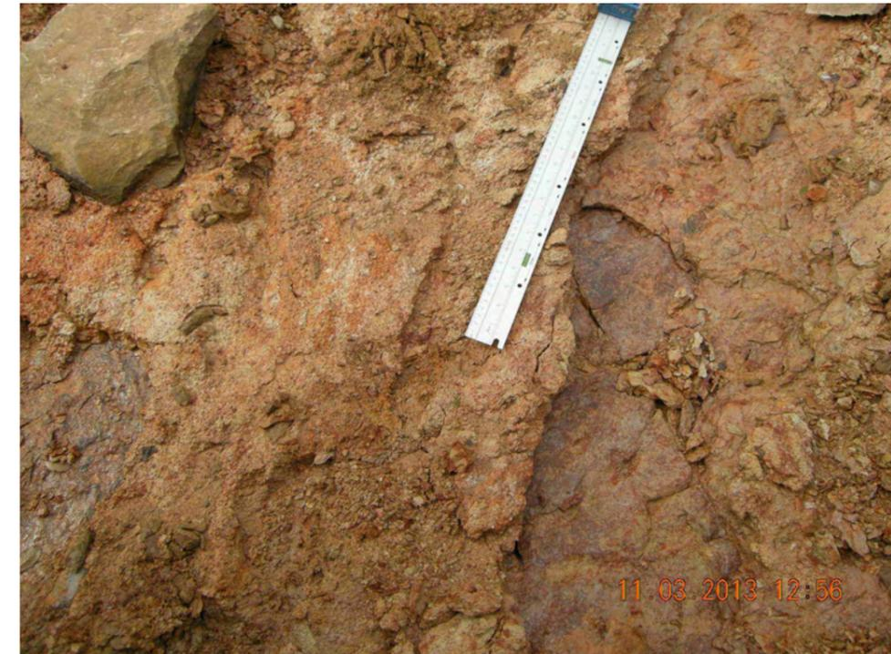
**Fotografía 31:** Detalle del nivel de despegue en el plano de deslizamiento en EGM-1.
