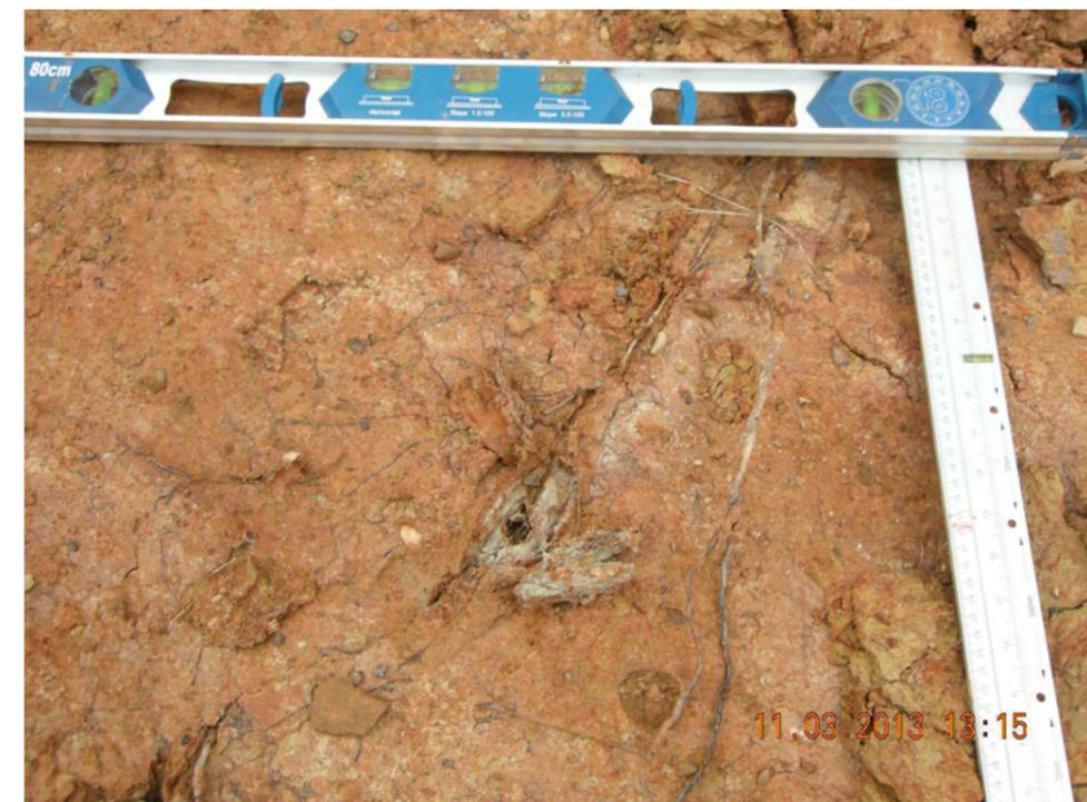
**Fotografía 32:** Detalle del nivel de despegue en el plano de deslizamiento en EGM-2. Nótese la presencia de raíces completamente aplastadas por el movimiento de los bloques.
