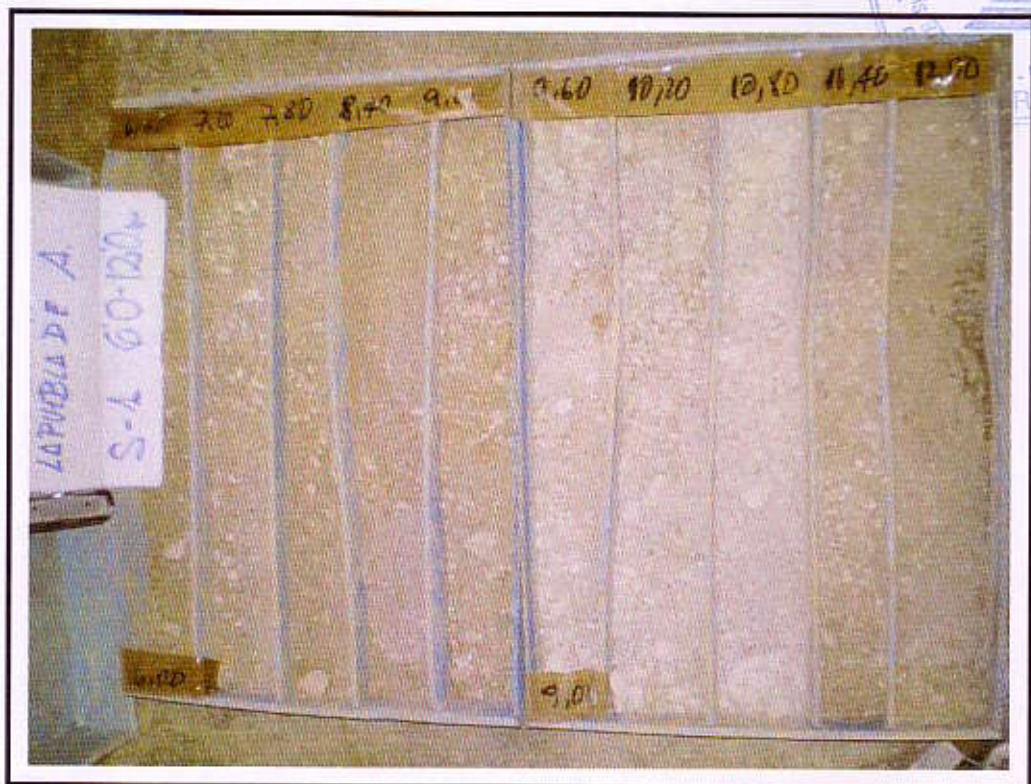
FOTO N°2-Sondeo n°1. Caja n°3 y 4. Cota 6.0 a 12.0 metros.
