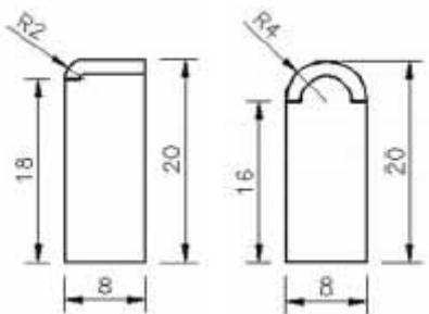
En todos los casos, los bordillos serán rectos o con la curvatura adaptada a su ubicación. La capa superficial (doble capa) será de espesor no inferior a uno con cincuenta centímetros (1,50 cm.).
