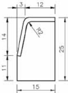
b) Bordillo prefabricado de hormigón tipo HM-35, de doble capa de protección extrafuerte en sus caras vistas de mortero M-400 en limitación de firmes y andadores, clase 2 según UNE-EN-1340.5.
